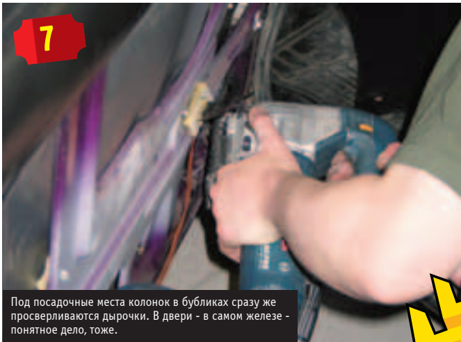
Собираем дверь. Сначала надеваем и фиксируем обивку. Затем со стороны двери внутрь вставляются болтики - каждый через шайбу и кусочек жидкой резины (она обычно идет в комплекте с колонками, с фурнитурой). Резина нужна, чтобы железки друг друга не обдирали и не ржавели. На них надевается кольцо из ДСП, а сверху - динамик. Конструкция фиксируется гайками.
